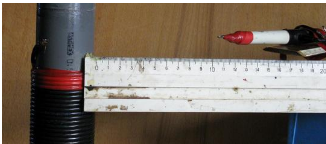
Рис. 8. Положение щупа осциллографа при снятии осциллограмм.
