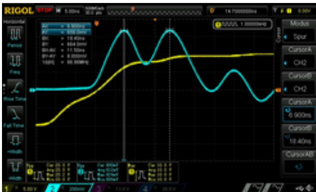
Messung FG an CMC → A: f=86,96\text{MHz}
