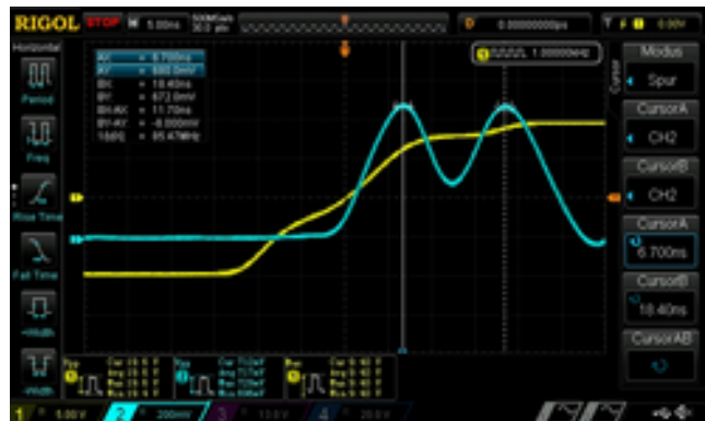
Messung FG an CMC → C: f=85,47\text{MHz}
